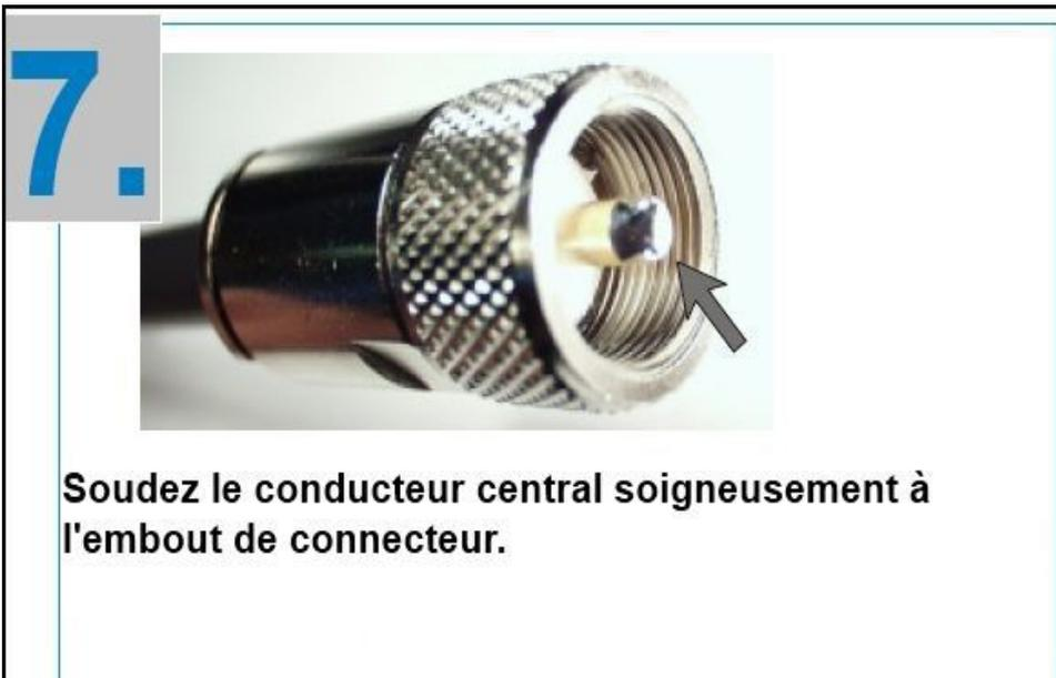
Montage AIRCELL 7 identique sauf en 3 dénuder 20 mm au lieu de 17 mm
