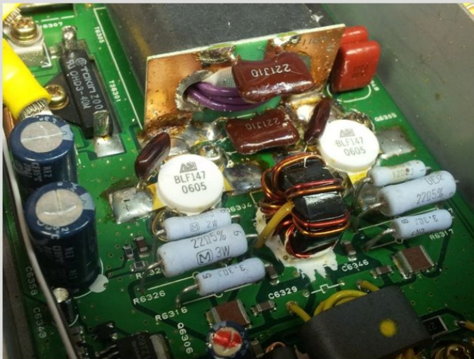
Exemple de PA de MARK-5 réparé ( pas par RCC !! ) avec des transistors pas d'origine ...
